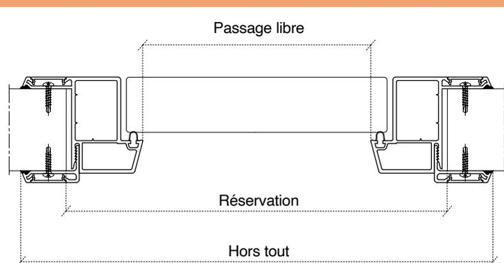
\* Il est conseillé de renforcer la périphérie de la trappe par des suspentes (douilles isolantes et tiges filetées) car la mise en place de celle-ci affaiblit la résistance du plafond.
