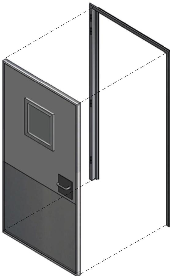
*“ Sortir la porte de sa caisse en bois et déposer le vantail ”*
