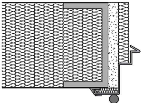
*“ A l'aide des bandes de laine de roche 30x50 fourni, combler le vide entre l'huissierie et la maçonnerie ”*
