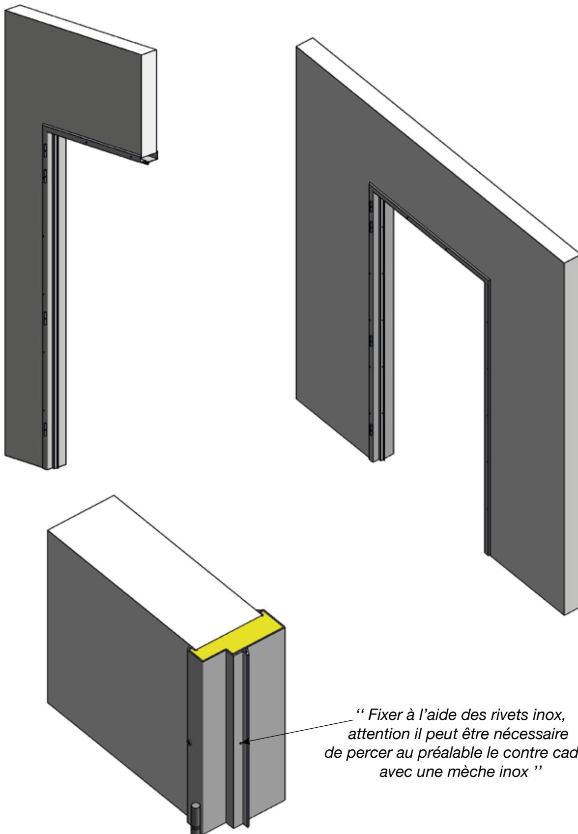
*“ Fixer à l'aide des rivets inox, attention il peut être nécessaire de percer au préalable le contre cadre avec une mèche inox ”*
